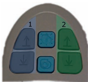
14. ábra A stimuláció nagyságát növelő és csökkentő gombok két oszlopban helyezkednek el.
