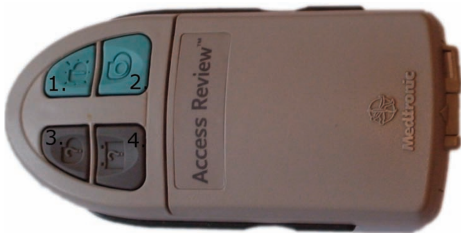
7. ábra A betegprogramozó előlapja. A stimulátor működését szabályzó gombok.
