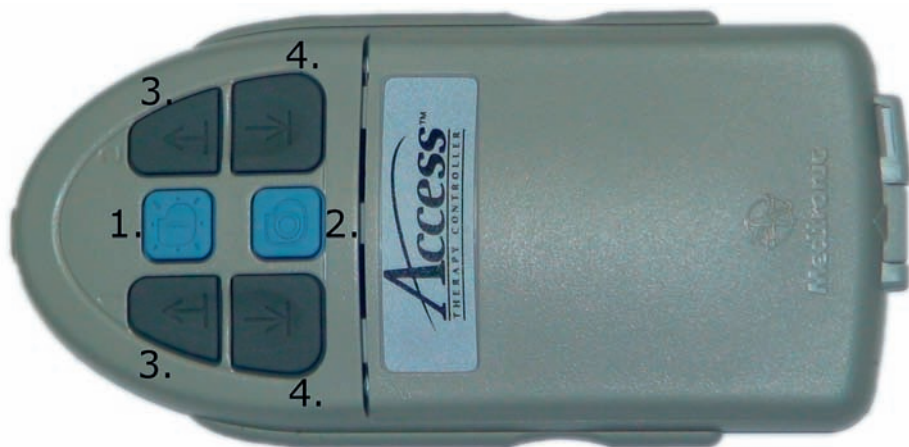
4. ábra A stimulátor működését szabályzó gombok a betegprogramozó előlapján találhatóak.
