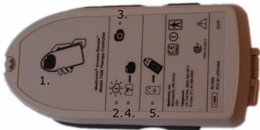
9. ábra A betegprogramozó kijelzői a hátoldalon találhatók.
